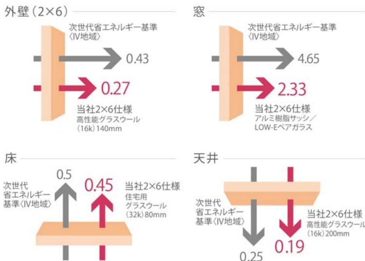
木材という断熱性に優れた基本素材に加え、高性能グラスウールで家全体を隙間なく包み込むことで、高い断熱性能を実現します。
