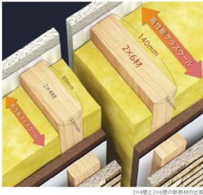
2×4壁と2×6壁の断熱材の比較
