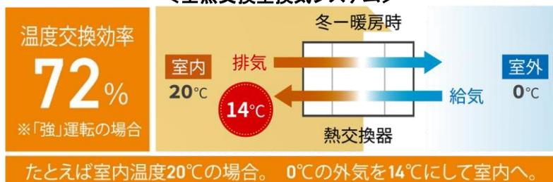
「全熱交換型換気システム」は、室内の暖かさを再利用(熱回収)することができるシステムで、換気中でも室温を逃しません。屋内外の温度の変化を少なくした状態で空気の入れ換えをすることができ、快適な室温を維持します。
