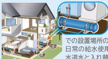
床下給水経路内に飲料水を備蓄し、断水時には容易に取水できるシステムです。床下の配管スペースに設置するため、居住スペースでの設置場所の確保が不要です。また日常の給水使用によって常に新鮮な水道水と入れ替わるので衛生的です。
